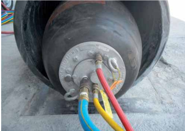
Foto 8.8 Tapón para prueba de hermeticidad con aire a baja presión
