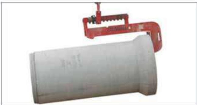
Foto 5.3 y 5.4 Ejemplos de levante de tubería.
